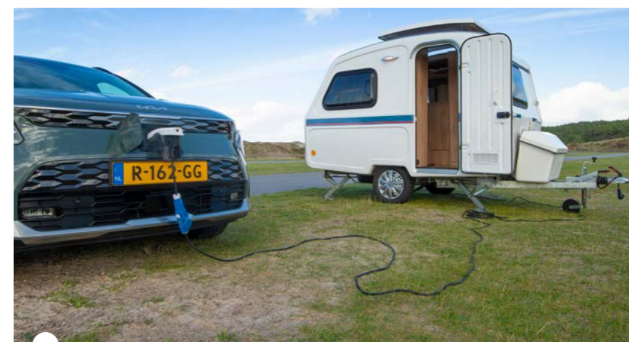
Da's handig! De laadpoort van de Niro kan ook als 230V/16A-stopcontact dienen, bijvoorbeeld om de caravan op aan te sluiten
